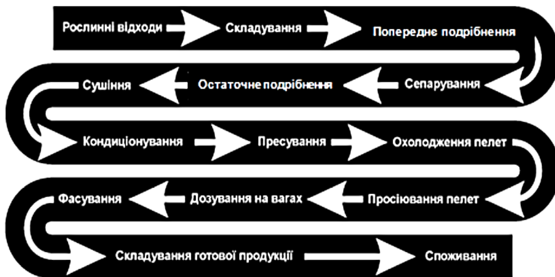
Рисунок 3.4 – Технологічна послідовність виготовлення пелет з рослинних відходів
