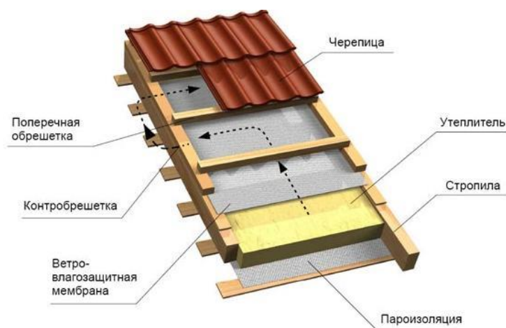
Рис. 3.3 Схема монтажу утеплювача на дахове перекриття
